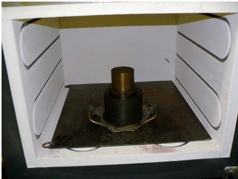
Obr. 1 Výroba vzorku kompozitního materiálu v elektrické peci
