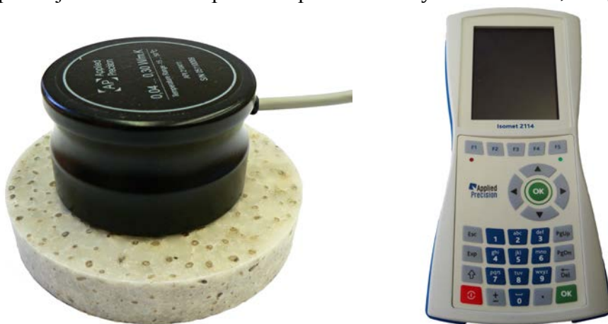
Obr. 2 a) Příločná sonda s rozmezím 0,04\text{--}0,30\text{ W/m.K} , b) Isomet 2114 ... shodné hmotnosti těchto vrstev. Pro výrobu daných vzorků byl použit totožný výrobní proces – byly vystaveny teplotě 300^{\circ}\text{C} po dobu 2 hodin. Po vychladnutí vzorků na pokojovou teplotu 21^{\circ}\text{C} na nich byla
