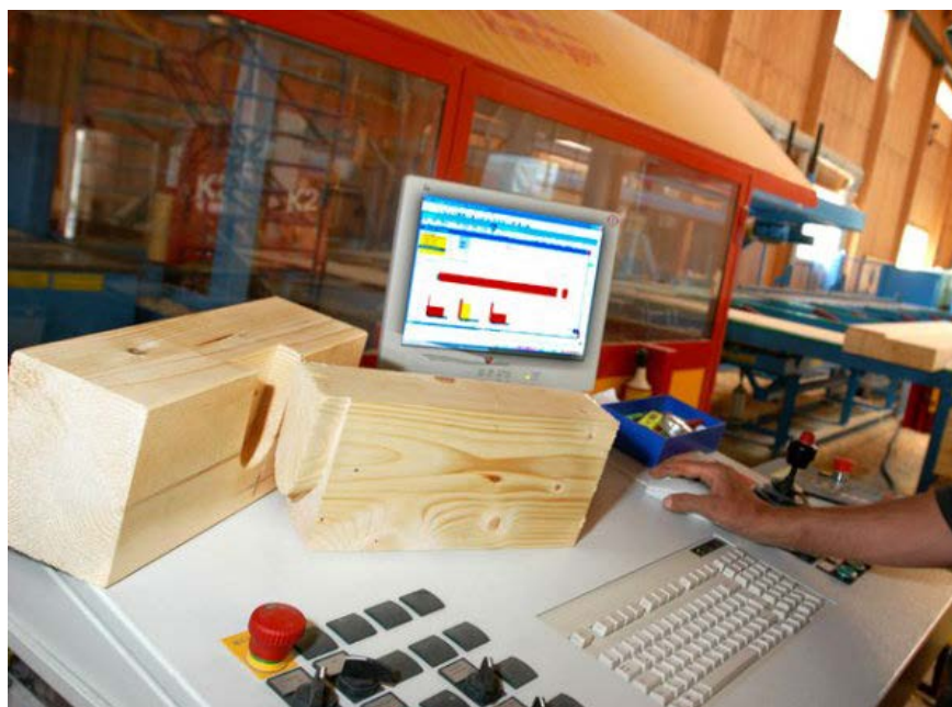
Obr. 8 Riadiaca jednotka drevoobrábacej linky Hundegger (Zdroj: http://www.frommelt.ag/intelligenter-holzbau/frommelt-als-unternehmen/traditionell-bauen )
