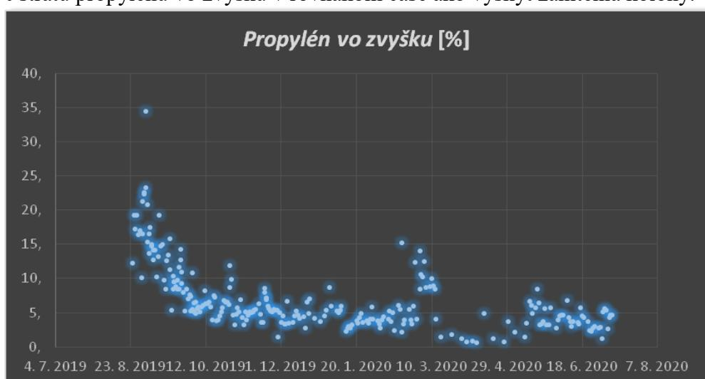
Obr.3. Priebeh obsahu propylénu po nábehu po generálnej revízii.
